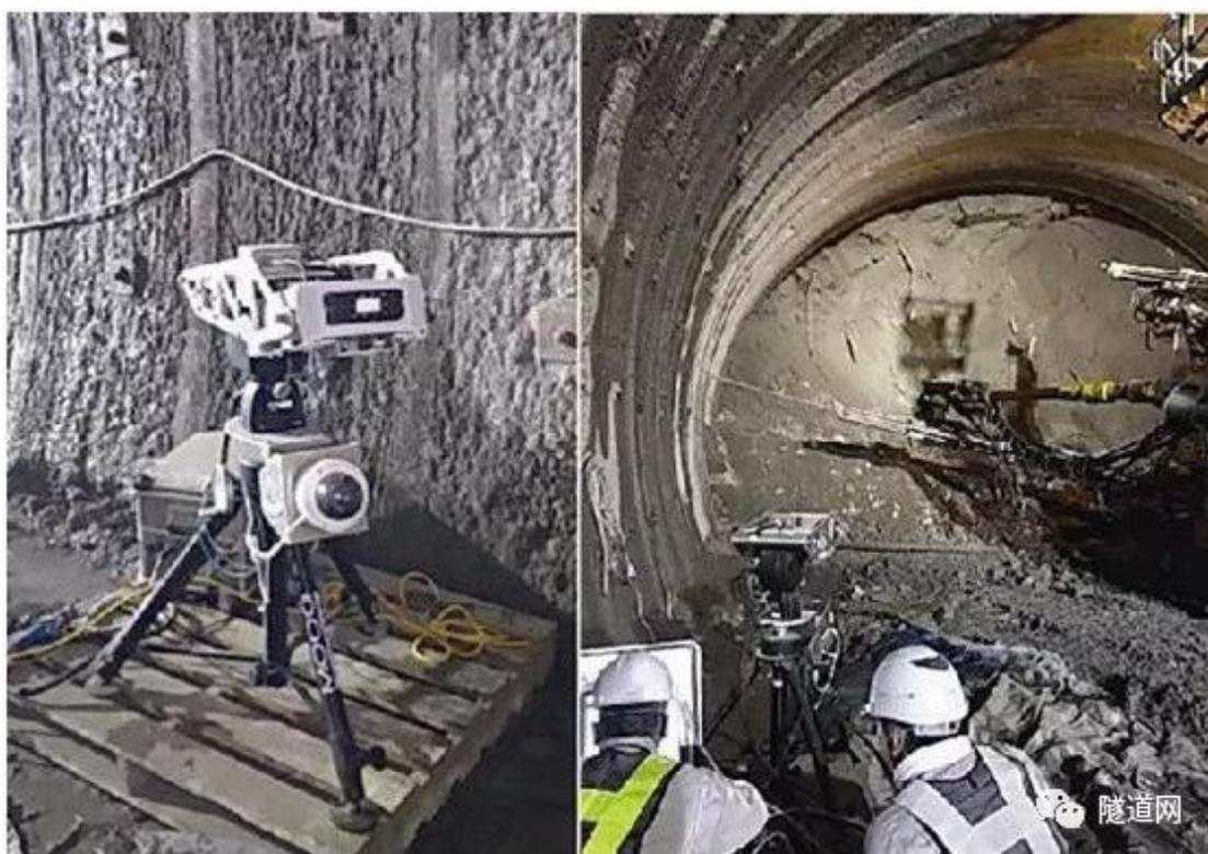
这项新系统是由 76~77GHz 频率范围的毫米波雷达结合数码相机的一体化测量系统、控制系统用的计算机以及记录用的硬盘构成。开挖面的位移状况可通过计算机实时显示的位移量与位移速度分布图进行确认，并配合开挖面实时影像达到可视化。当系统捕捉到超过标准值的坍塌预兆时，将通过闪光信号、警报音和屏幕显示发出注意、警告、疏散三个阶段的警示。
