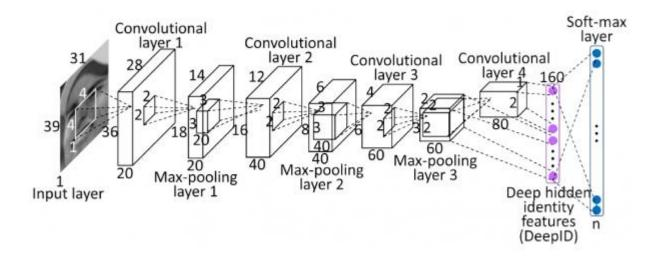
上图中的结构,在最后只有一层全连接层,然后就是 softmax 层了。论文中就是以该全连接层作为图像的表示。在全连接层,以第四层卷积和第三层 max-pooling 的输出作为全连接层的输入,这样可以学习到局部的和全局的特征。
