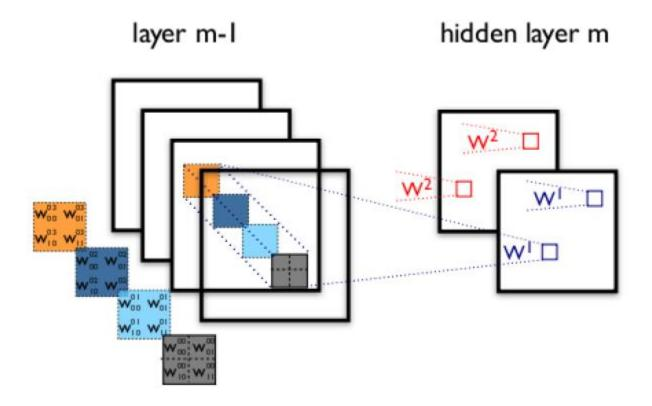
所以,在上图由 4 个通道卷积得到 2 个通道的过程中,参数的数目为 4×2×2×2 个,其中 4 表示 4 个通道,第一个 2 表示生成 2 个通道,最后的 2×2 表示卷积 核大小。
