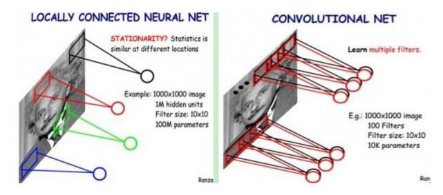
上图右,不同颜色表明不同的卷积核。每个卷积核都会将图像生成为另一幅图像。 比如两个卷积核就可以将生成两幅图像,这两幅图像可以看做是一张图像的不同 的通道。如下图所示,下图有个小错误,即将 w1 改为 w0, w2 改为 w1 即可。下 文中仍以 w1 和 w2 称呼它们。 下图展示了在四个通道上的卷积操作,有两个卷积核,生成两个通道。其中需要注意的是,四个通道上每个通道对应一个卷积核,先将 w2 忽略,只看 w1,那么在 w1 的某位置(i,j)处的值,是由四个通道上(i,j)处的卷积结果相加然后再取激活函数值得到的。
